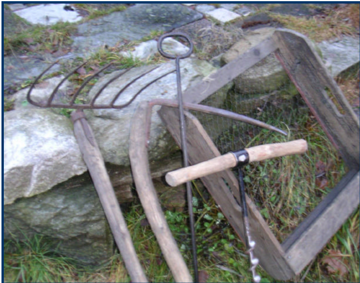
Några av kolarens verktyg: kolkarka, kolkrok, milspett, navare och kolfat.
