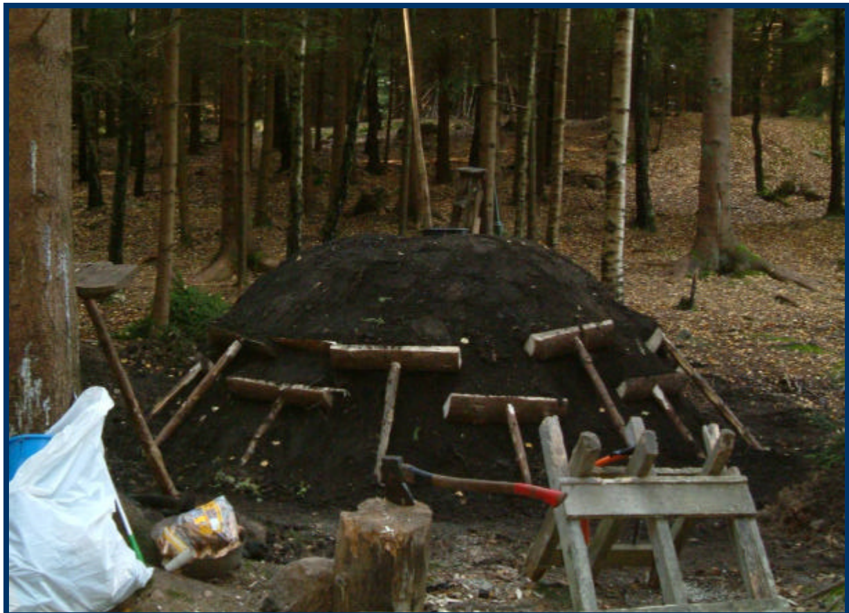
Milan är täckt med ett tjockt lager stybb. Blocken hindrar stybben från att rasa ned.
